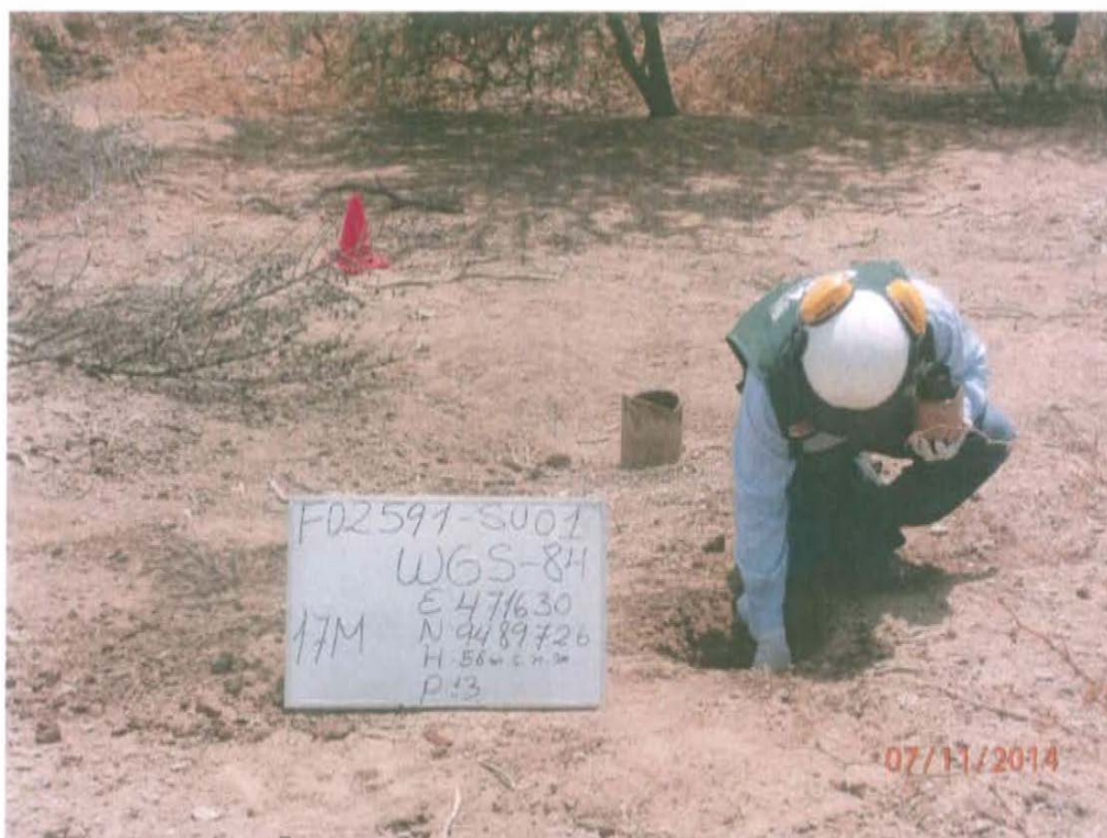
Fotografía N° 3. Toma de muestra de suelo en el punto F02591-SU01, ubicado a 0,65 m aproximadamente del Pozo T3883.
