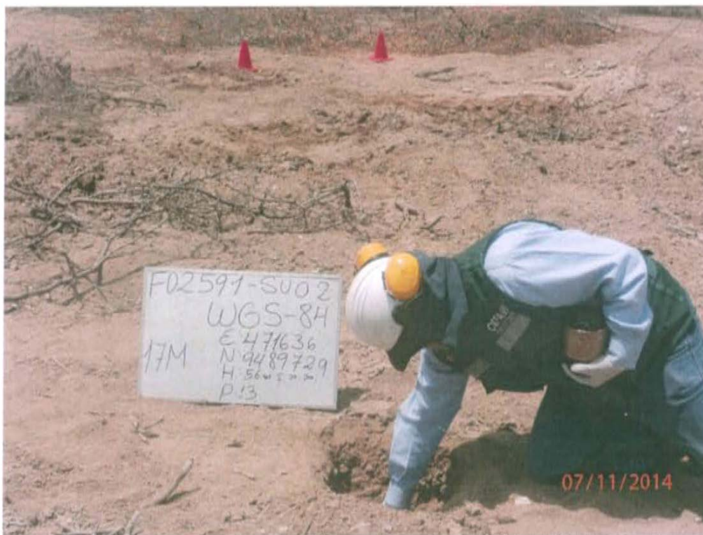
Fotografía N° 4. Toma de muestra de suelo en el punto F02591-SU02, ubicado a 9 m aproximadamente del Pozo T3883.
