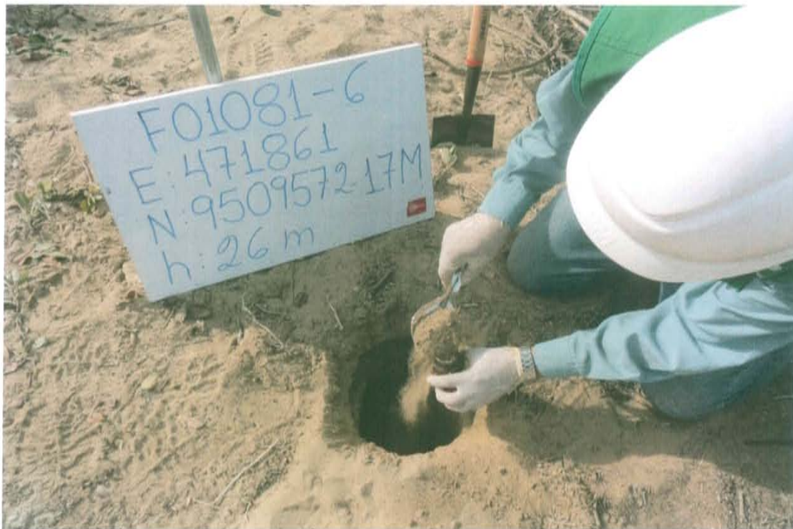
Fotografía N° 4. Toma de muestra de suelo en el punto F01081-6, ubicado a 3,4 m de distancia del casing del Pozo L1921.
