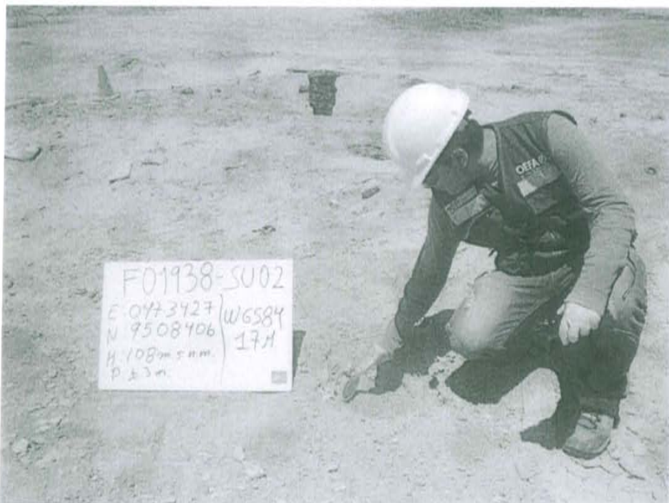
Fotografía N° 2. Toma de muestra de suelo en el punto F01938-SU02, ubicado a 4 m aproximadamente del Pozo L10028.
