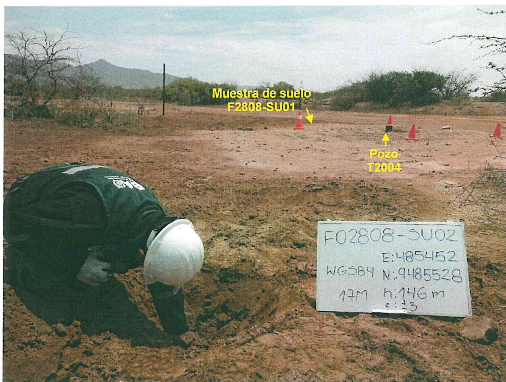
Fotografía N° 3. Toma de muestra de suelo en el punto F02808-SU02, ubicado a 7 m aproximadamente del Pozo T2004.
