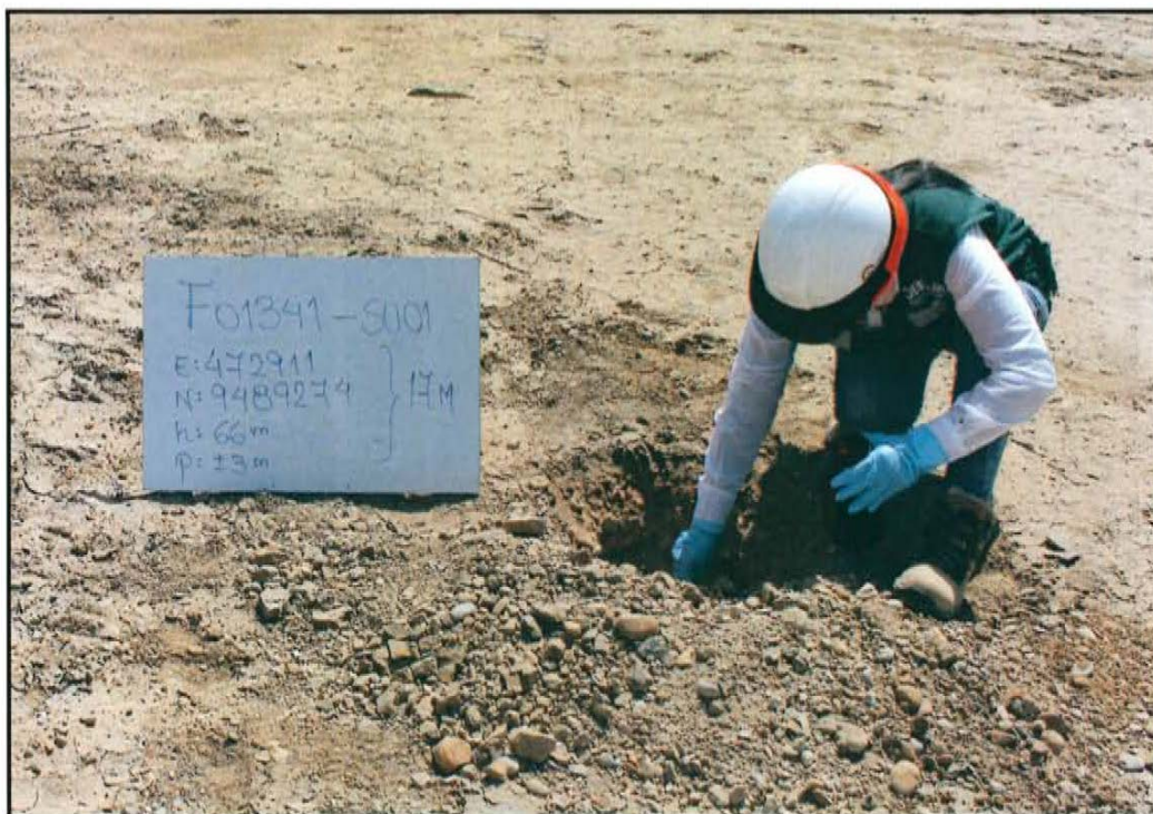
Fotografía N° 3. Toma de muestra en el punto F01341-SU01, ubicado a 2,3 m de distancia del casing del pozo T 2440 a una profundidad de 0,35 m de la superficie del suelo.
