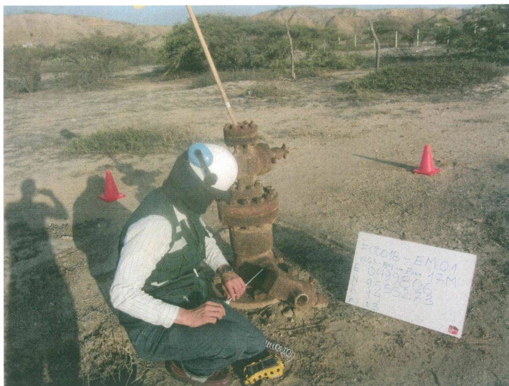
Fotografía N° 3. Medición en el punto F00018-EM01, se detectó una fuga al costado de cabezal en unión con válvula, el casing presenta signos de corrosión Pozo EC_65.
