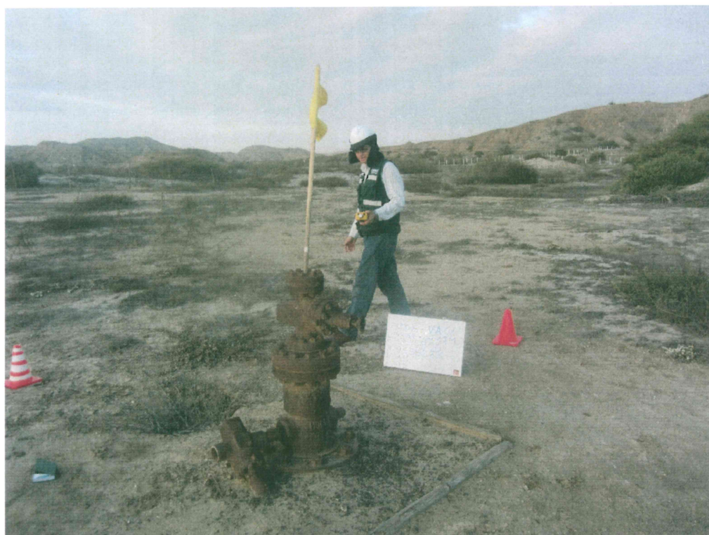
Fotografía N° 4. Mediciones en el F00018-VA01, se realizó en un recorrido en el área circundante alrededor del pozo EC_65 en un radio de 1 m, con una duración de 10 minutos.
