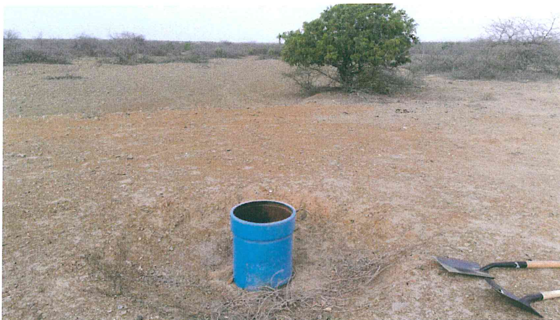
Fotografía N° 1. Ubicación del pozo T2070 con una tubería de revestimiento expuesto 0,5 m sobre la superficie del suelo.
