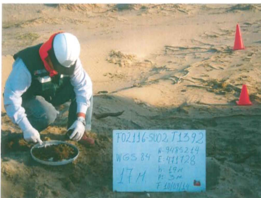
Fotografía N° 4. Vista de la toma de muestra de suelo realizado en el área de ubicación del pozo en el punto F02116-SU02.
