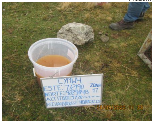
Fotografía 5.6. Turbiedad observada en las muestras de los piezómetros YMW15 y CYMW4.
