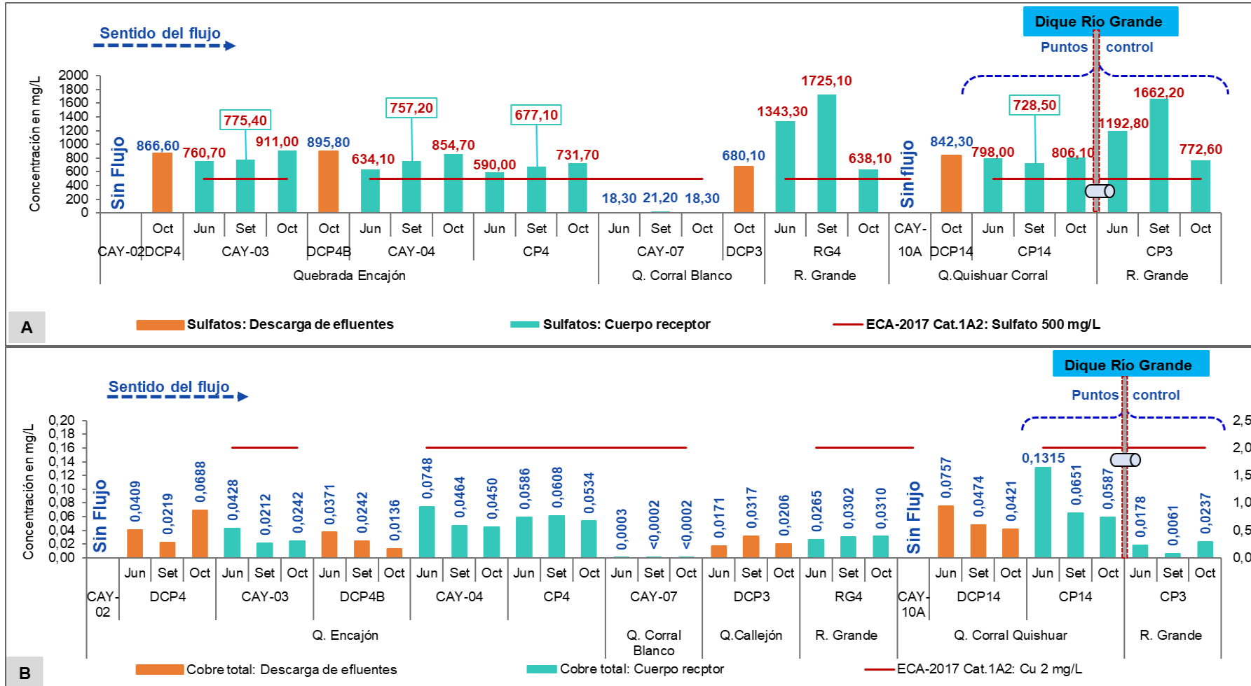
Figura 5.34. Concentraciones de sulfatos (A) y cobre total (B) registrados durante el 2022 en los puntos ubicados en la microcuenca del río Grande comparados de manera referencial con el ECA 2017.
