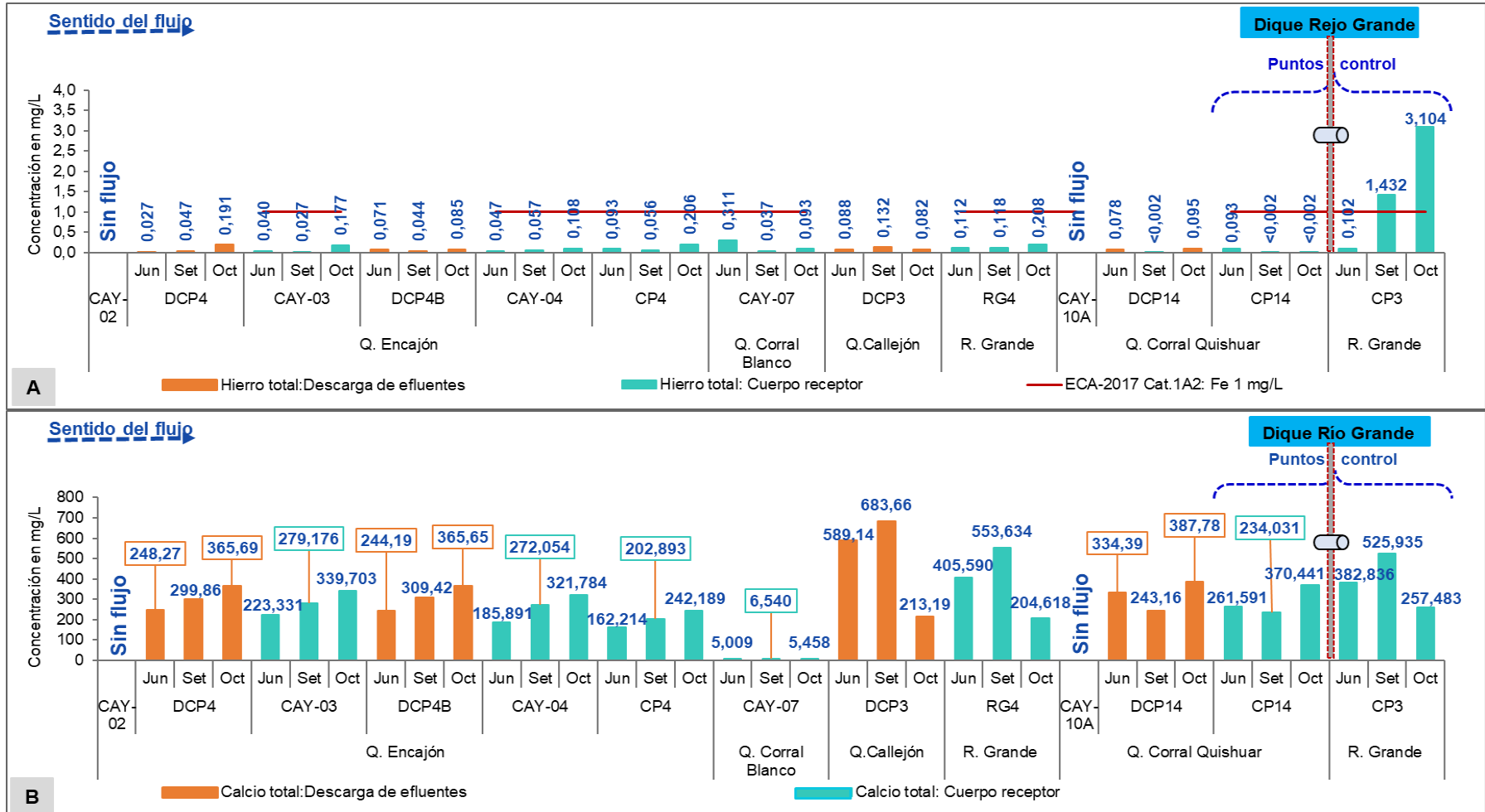
Figura 5.35. Concentraciones totales de hierro (A) y calcio (B) registrados durante el 2022 en los puntos ubicados en la microcuenca del río Grande comparados de manera referencial con el ECA 2017.
