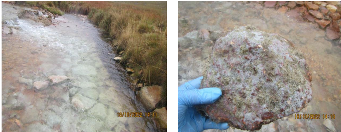
Fotografía 5.3. Precipitado de color blanquecino verdoso en el lecho del cauce de la descarga del efluente minero VERT-RSJ ubicado en la microcuenca del río San José.
