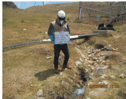
Fotografía 5.7. Flujo con precipitado de color blanquecino ubicado a 8 metros del Parshall de la descarga del efluente minero DCP11, el cual se identificó como ESP-1 en setiembre 2022.
