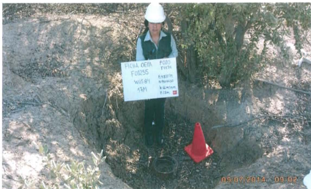
Fotografía N° 2. Vista del pozo, ubicado aproximadamente a 247 m de la quebrada Honda, presenta casing de 10 pulgadas de diámetro, sobresale aproximadamente 0,1 metro de la superficie del suelo. No se observa afloramiento de líquidos, pero si se perciben emisiones gaseosas de hidrocarburos.
