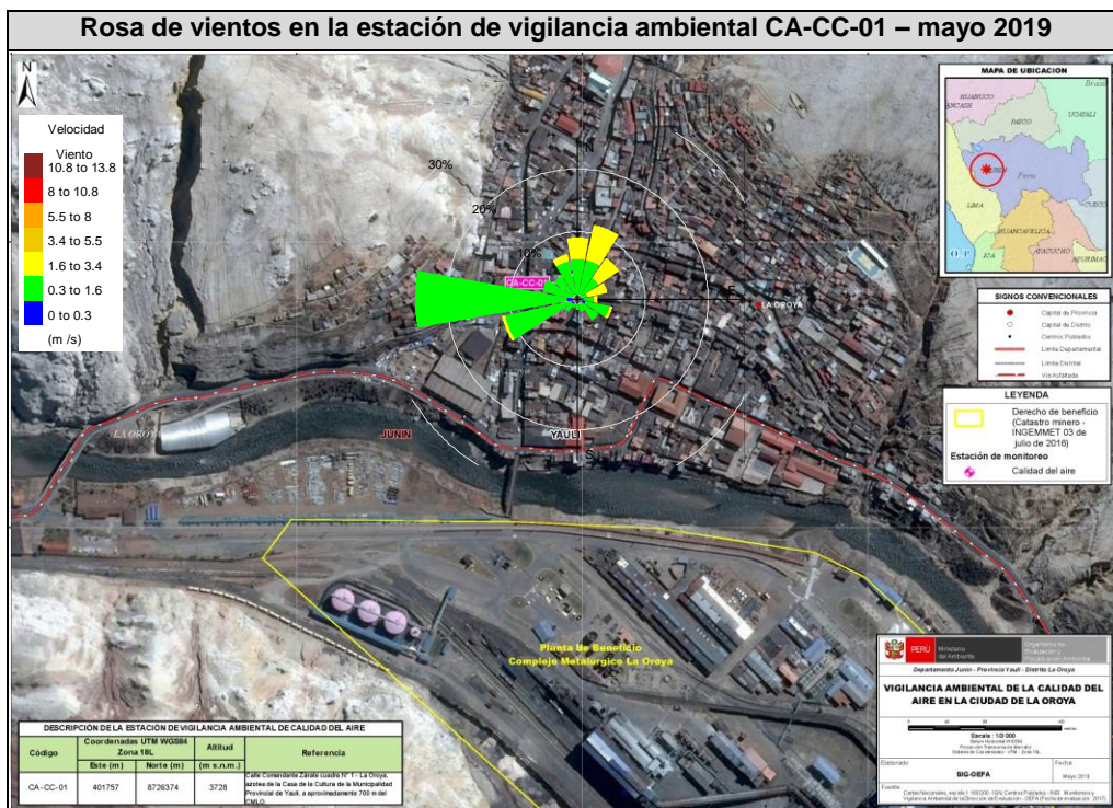
Figura 5.2. Ubicación de la estación de vigilancia ambiental CA-CC-01 y rosa de vientos en mayo de 2019.
