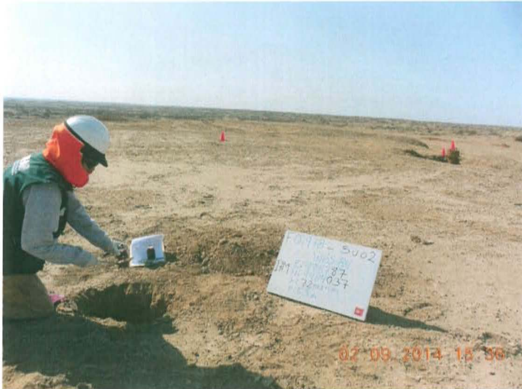
Fotografía N° 5. Toma de muestra de suelo en el punto F01748-SU02, ubicado a 4 m aproximadamente del Pozo T2552.
