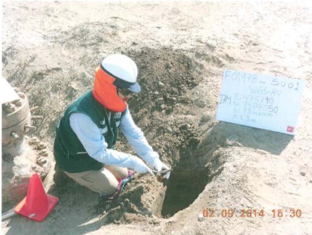
Fotografía N° 4. Toma de muestra de suelo en el punto F01748-SU01, ubicado a 0,90 m aproximadamente del Pozo T2552.
