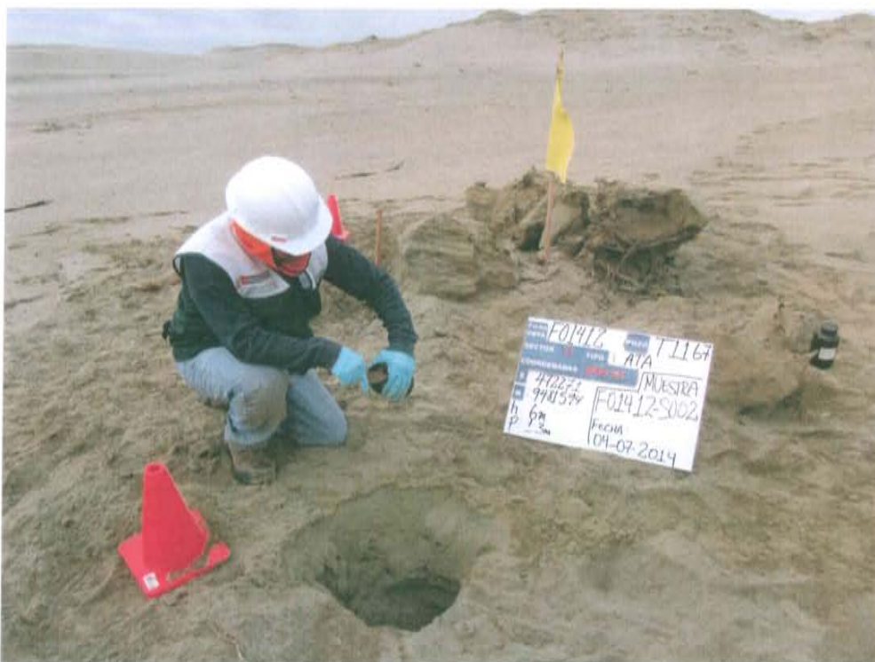
Fotografía N° 4. Toma de muestra de suelo en el punto F01412 -SU02, ubicado a 2,4 m del Pozo T1167.
