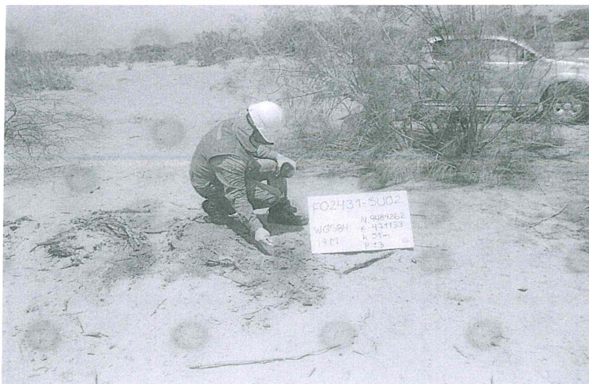
Fotografía N° 2. Toma de muestra de suelo en el punto F02431-SU02, ubicado a 8 m de la posible ubicación del casing del pozo.
