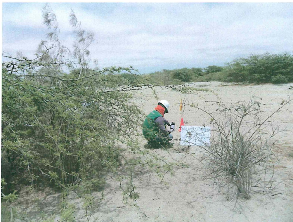
Fotografía N° 3. Toma de muestra de suelo en el punto F02431-SU01, ubicado a 3,4 m de la posible ubicación del casing del Pozo.
