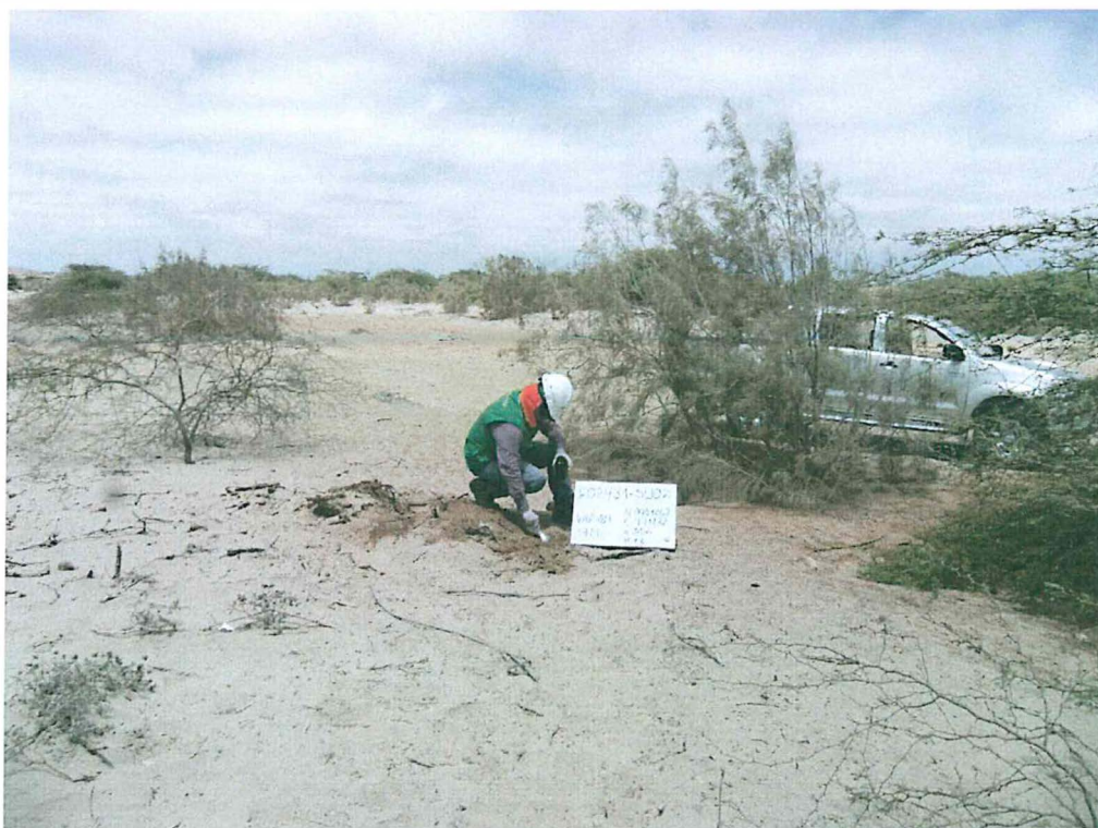
Fotografía N° 4. Toma de muestra de suelo en el punto F02431-SU02 ubicado a 8 m de la posible ubicación del casing del Pozo.
