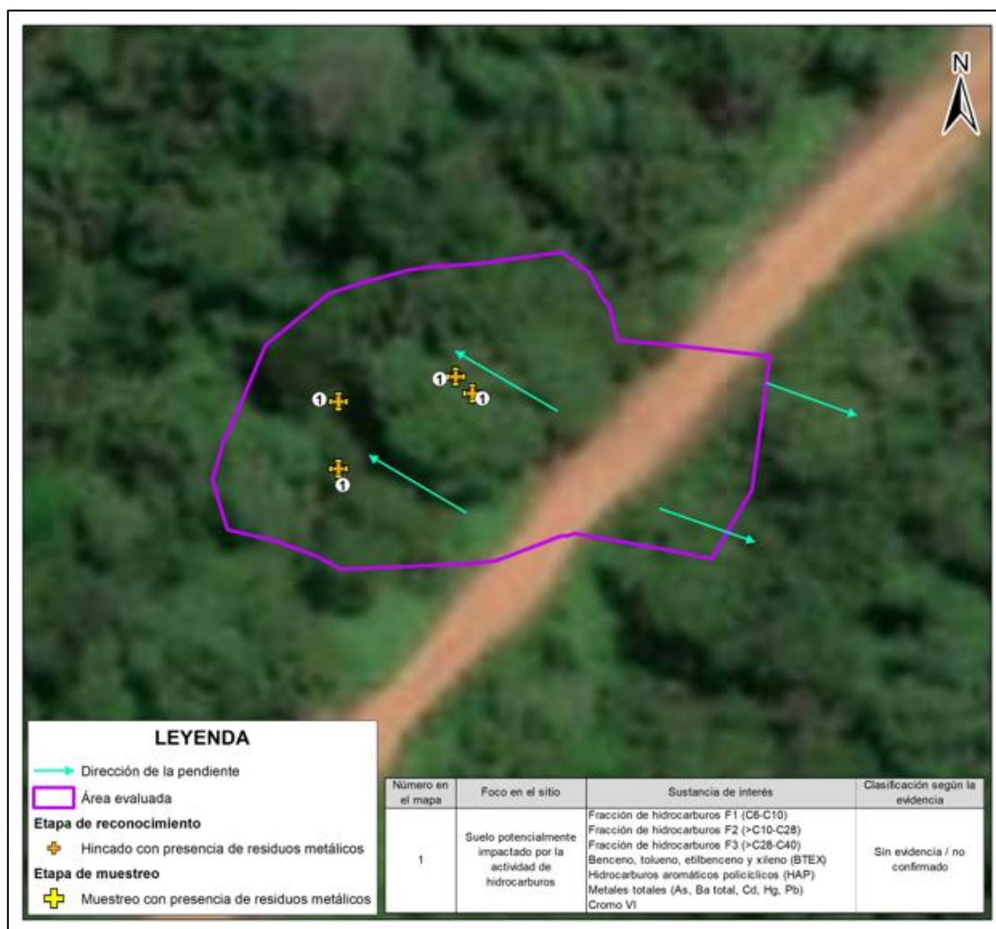
Figura 3.3. Posibles focos de contaminación en el sitio S0610
