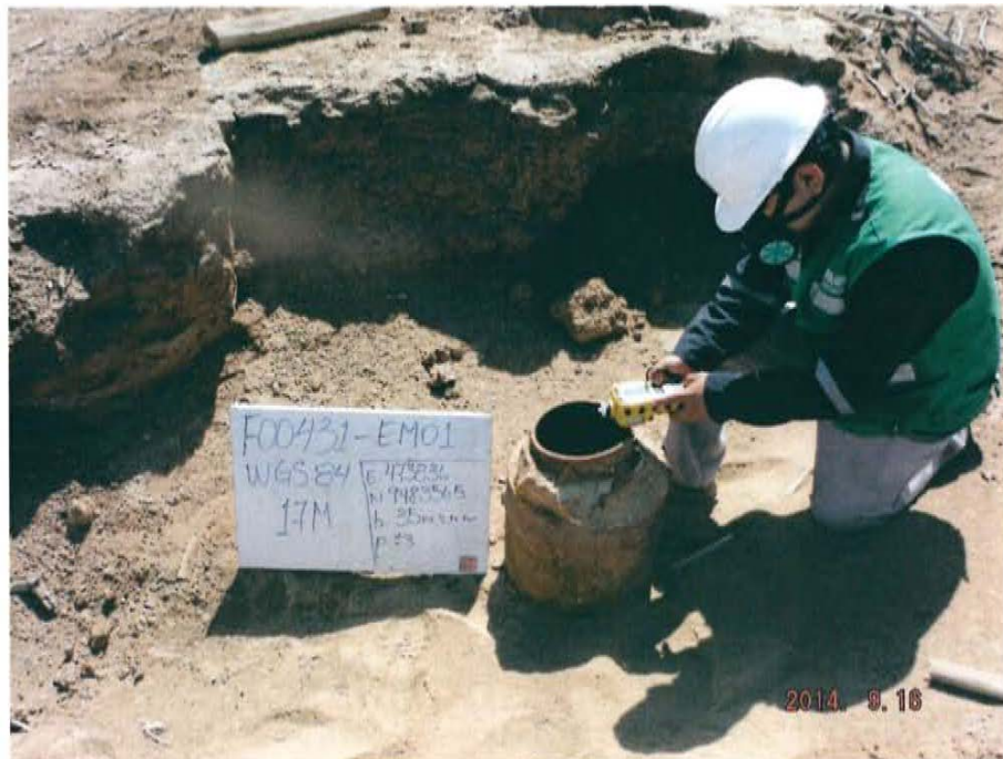
Fotografía N° 4. Medición en el punto F00431-EM01, ubicado en la fuente de emisión en boca del Pozo T1625.
