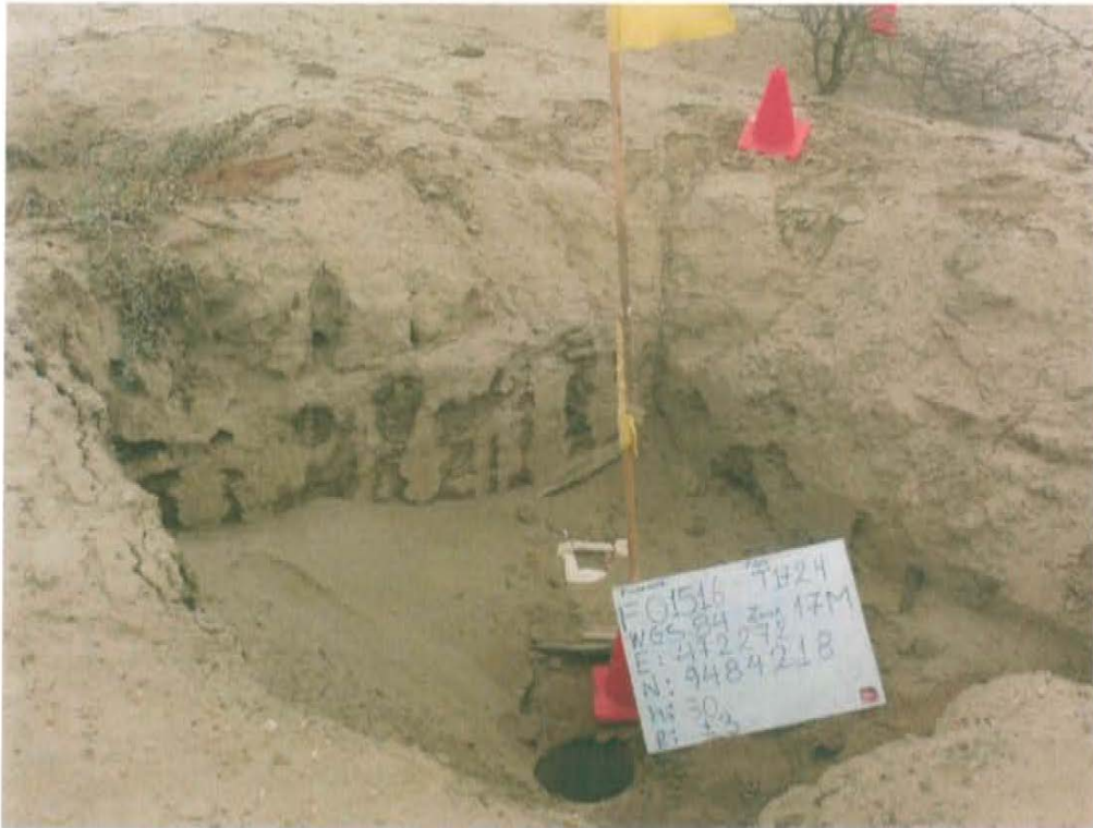
Fotografía N° 1. Identificación del pozo inactivo con código PERUPETRO T1724. Presenta casing abierto al medio ambiente.
