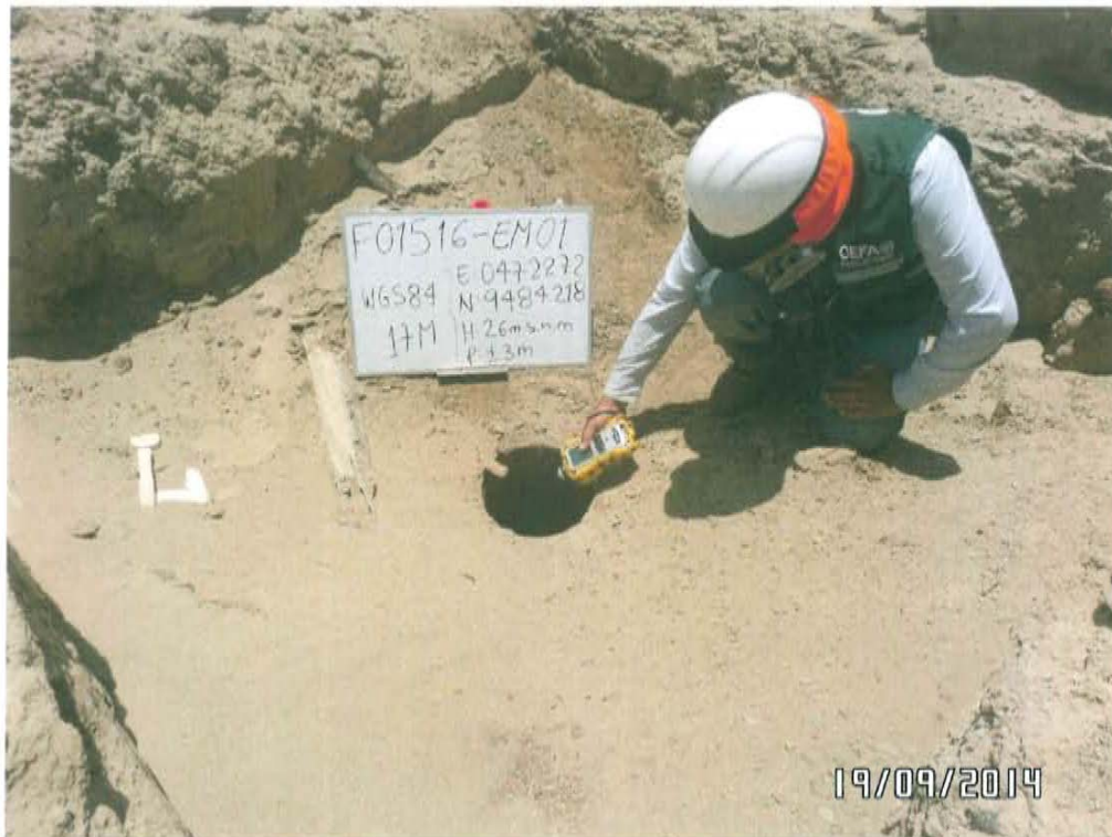
Fotografía N° 4. Medición en el punto F01516-EM01, ubicado en la fuente de emisión en boca del Pozo T1724.
