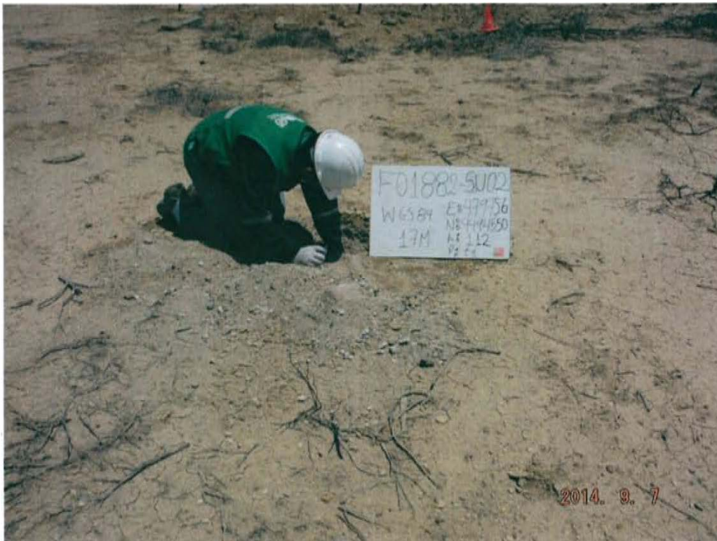
Fotografía N° 3. Muestra de suelo puntual a 3 m al sureste del pozo, suelo de textura arenosa con presencia de grava.
