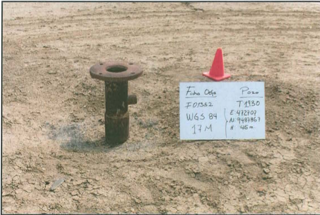
Fotografía N° 1. Pozo T 1930 presenta cabezal de pozo compuesto por brida de 15 pulg, el cual une al casing de 8 plg que emerge 0,5 m desde la superficie del suelo.
