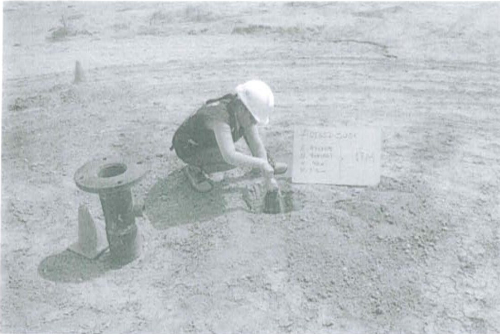
Fotografía N° 1. Toma de muestra en el punto F01352-SU01, ubicado a 0,9 m de distancia del casing del pozo T 1930 a una profundidad de 0,35 m de la superficie del suelo.
