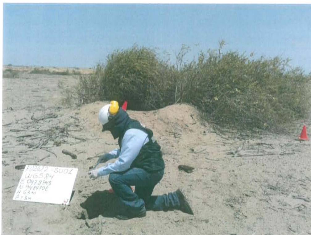
Fotografía N° 3. Toma de muestra de suelo en el punto F02012-SU01, ubicado a 4,5 m aproximadamente del Pozo T2965.
