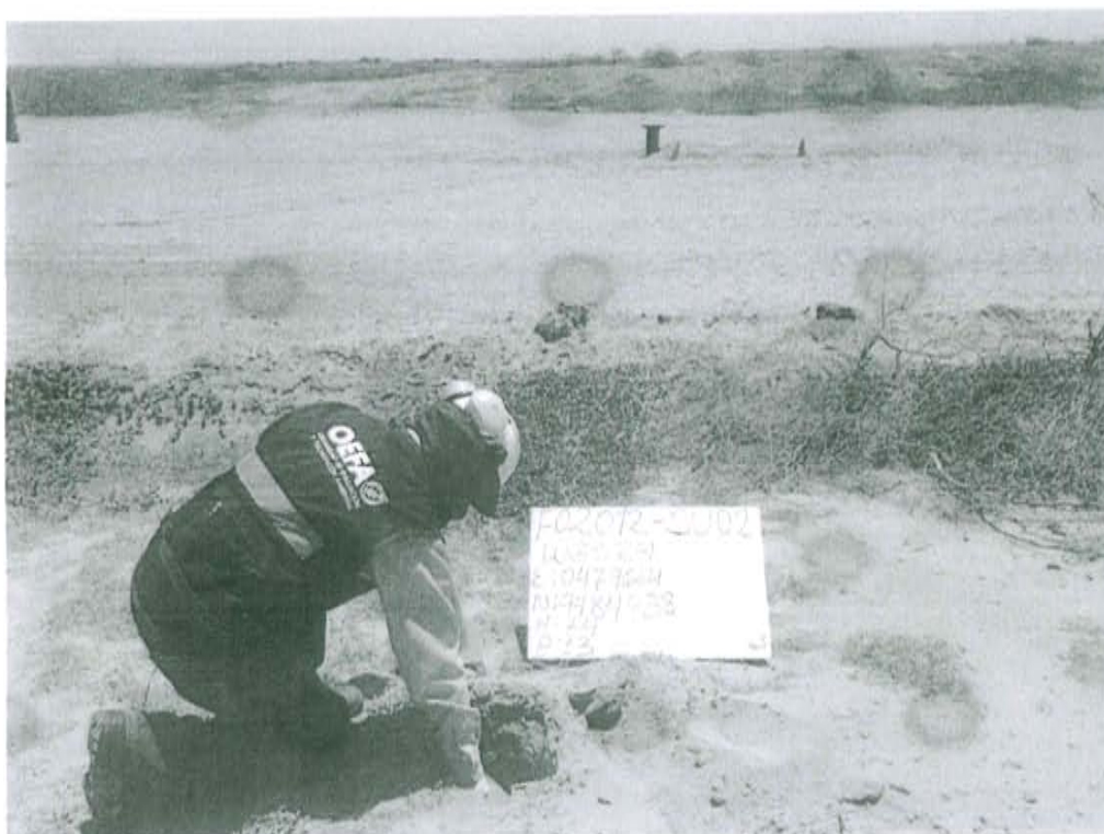
Fotografía N° 2. Toma de muestra de suelo en el punto F02012-SU02, ubicado a 9,5 m aproximadamente del Pozo T2965.
