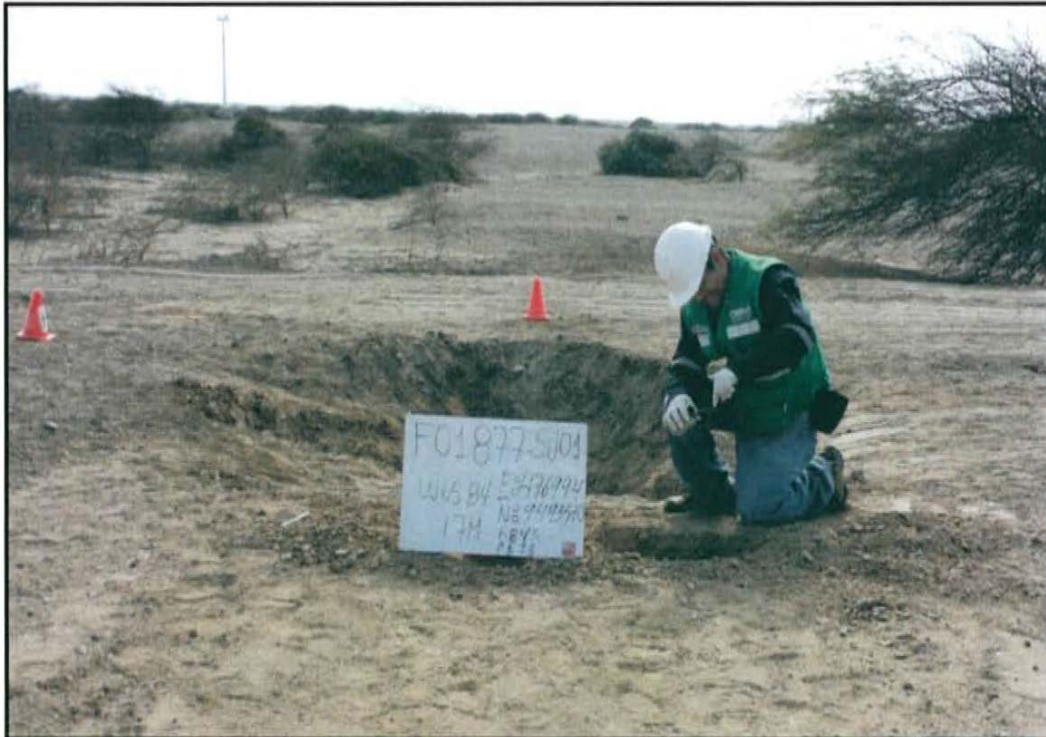
Fotografía N° 3. Recojo de muestras de suelo impregnado con hidrocarburo en zonas adyacentes al pozo.
