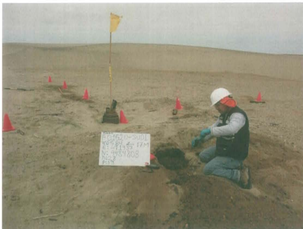
Fotografía N° 3. Toma de muestra de suelo en el punto F01520-SU01, ubicado aproximadamente a 3 m al norte del Pozo T1371.
