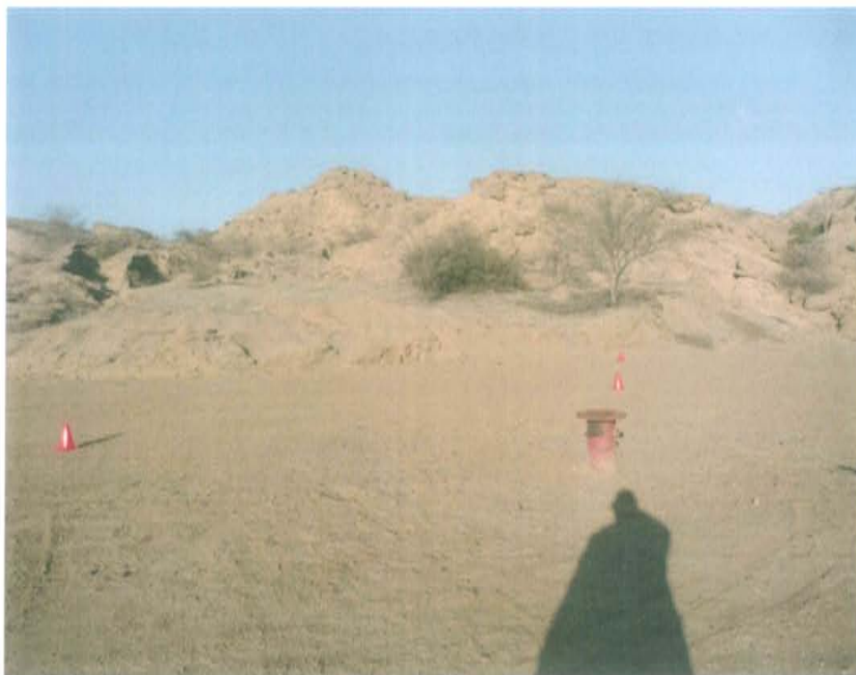
Fotografía N° 1. Vista del Pozo L_411, cabezal compuesto de brida de 18 pulgadas unida a un casing de 9 pulgadas.
