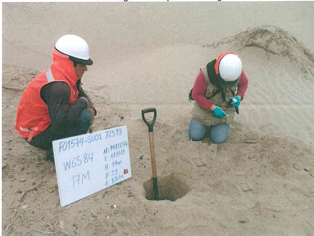
Fotografía N° 4. Toma de muestra F01574-SU01 ubicado a 20m. de la posible ubicación del pozo enterrado.
