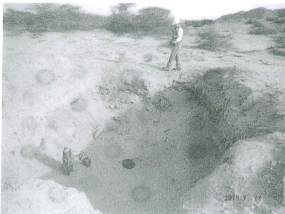
Fotografía N° 2. Mediciones en el F02057-VA01, se realizó en un recorrido en el área circundante alrededor del Pozo en un radio de 1 m, con una duración de 10 minutos.
