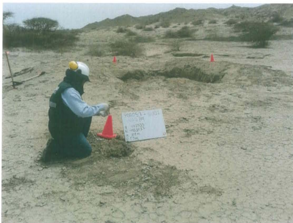
Fotografía N° 3. Toma de muestra de suelo en el punto F02057-SU01, ubicado aproximadamente a 4,5 m al sur del Pozo T1782.
