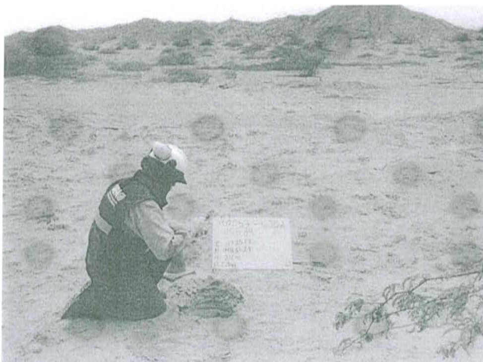
Fotografía N° 2. Toma de muestra de suelo en el punto F02057-SU02, ubicado a 13 m aproximadamente del Pozo T1782.
