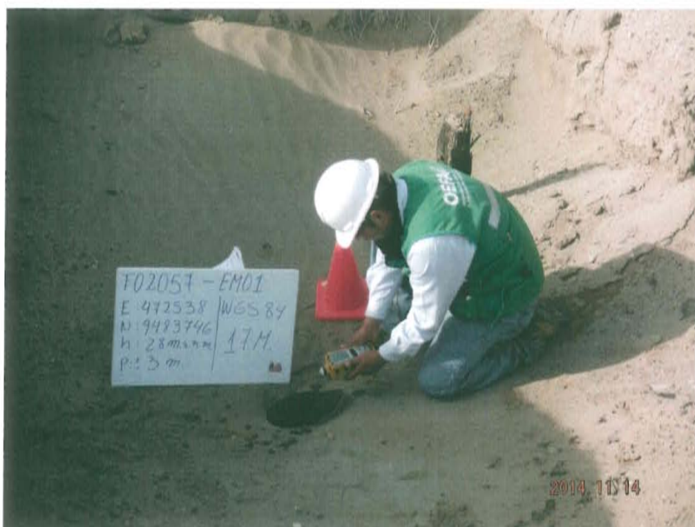
Fotografía N° 4. Medición en el punto F02057-EM01, ubicado en la fuente de emisión en boca del Pozo T1782.
