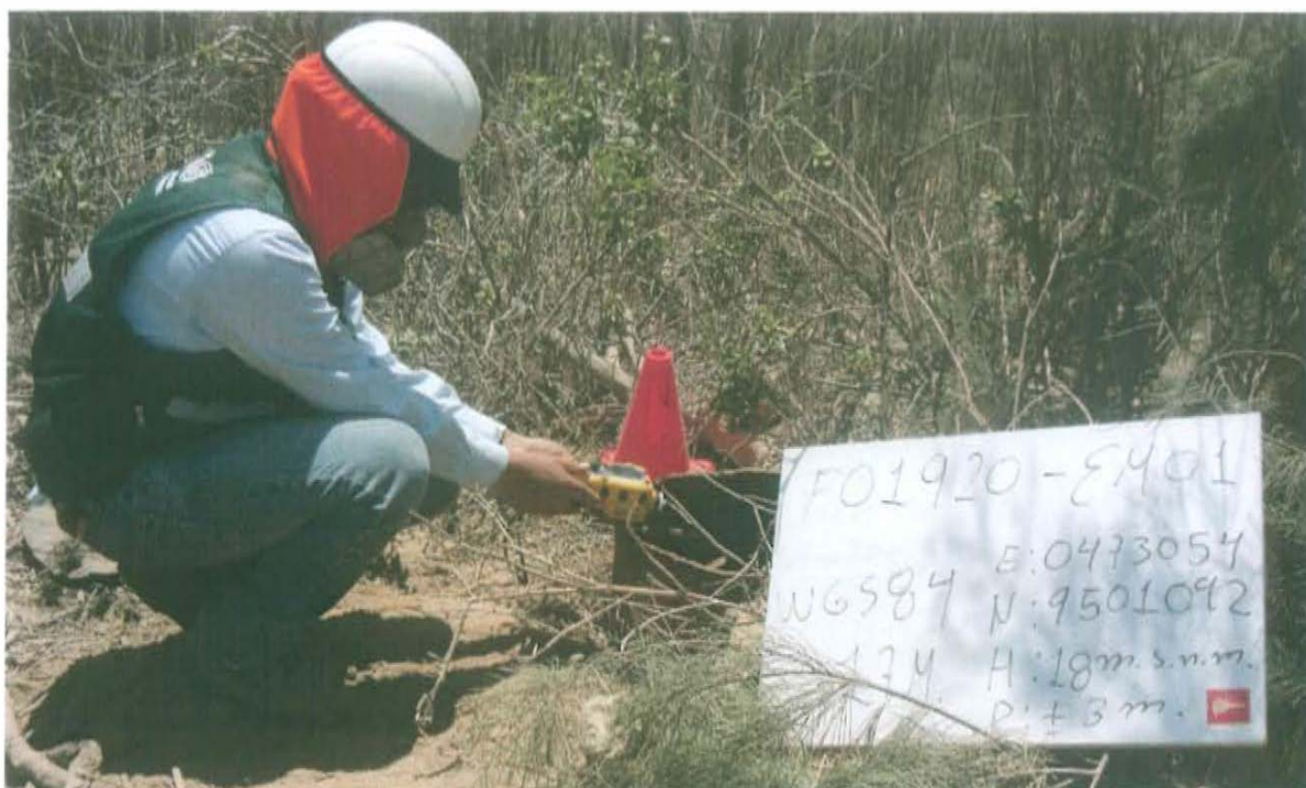
Fotografía N° 5. Medición en el punto F01920-EM01, ubicado en la fuente de emisión en boca del pozo T3748.
