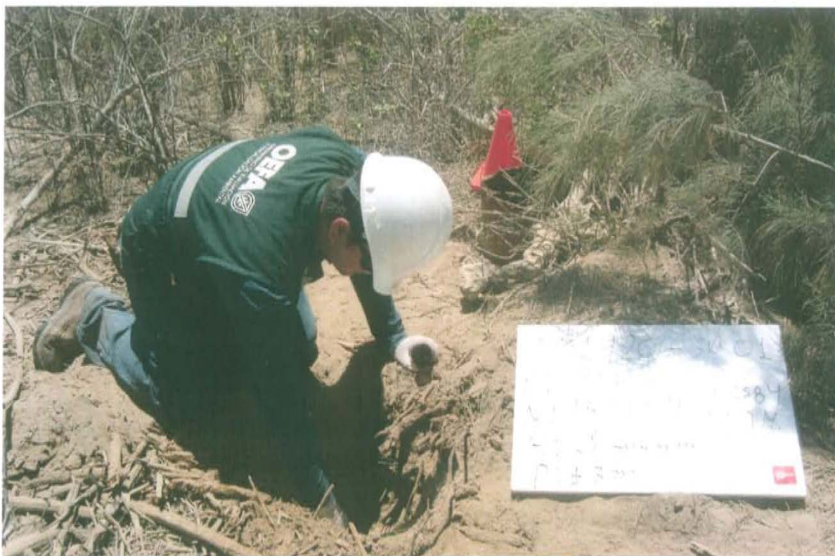
Fotografía N° 3. Toma de muestra de suelo en el punto F01920-SU01, ubicado a 1,5 m aproximadamente del Pozo T3748.
