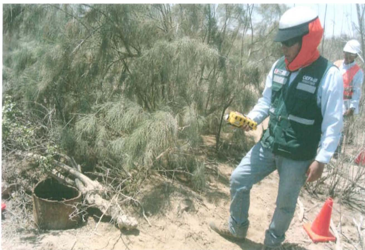
Fotografía N° 6. Mediciones en el punto F01920-VA01, se realizó un recorrido en el área circundante alrededor del pozo T3748, en un radio de 1 m aproximadamente y con una duración de 10 minutos.
