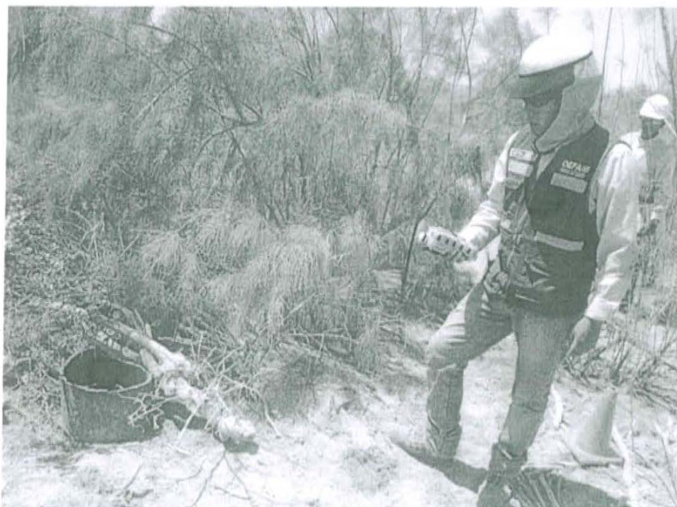
Fotografía N° 2. Mediciones en el F01920-VA01, se realizó en un recorrido en el área circundante alrededor del Pozo en un radio de 1 m, con una duración de 10 minutos.
