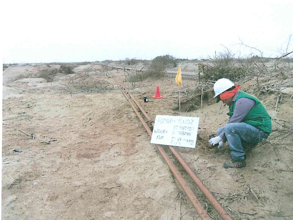
Fotografía N° 4. Toma de muestra de suelo en el punto F02420-SU02 ubicado a 2,5 m de la posible ubicación del casing del pozo.
