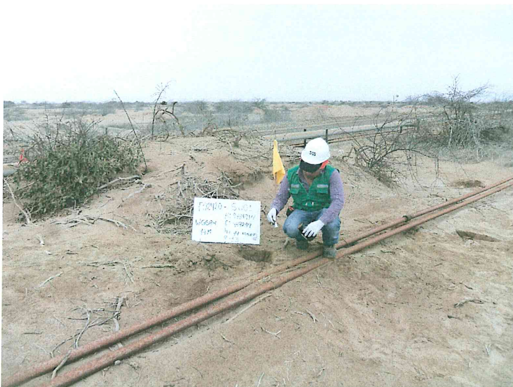
Fotografía N° 3. Toma de muestra de suelo en el punto F02420-SU01, ubicado a 1,2 m de la posible ubicación del casing del pozo
