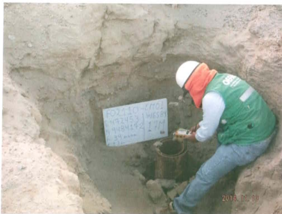
Fotografía N° 4. Medición de gases en boca del pozo FO2110-EM01
