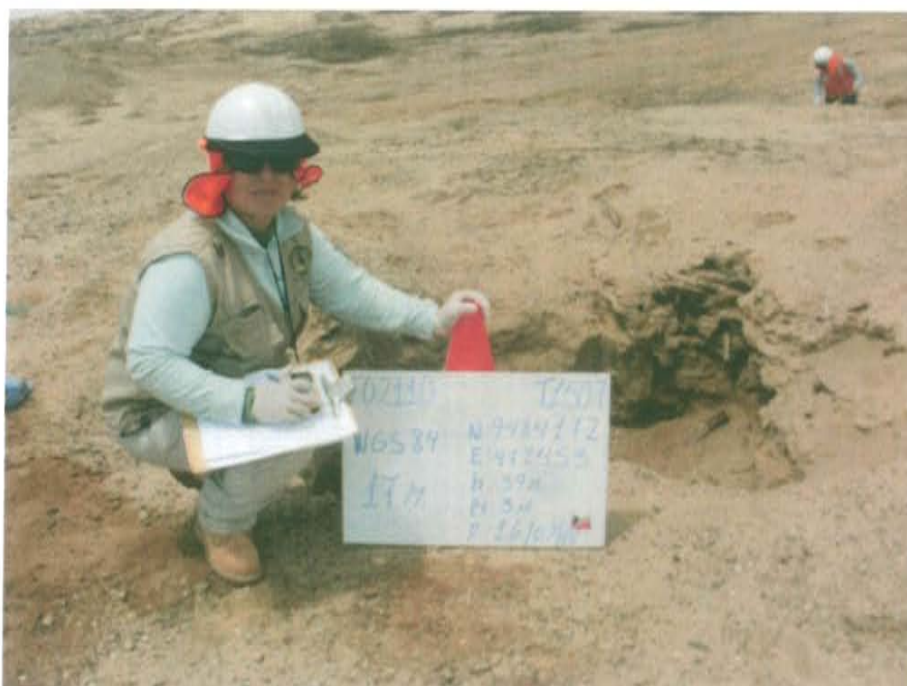
Fotografía N° 2. El Pozo T1507 se ubica dentro de un hoyo de sección circular, superficialmente se observan restos de madera y suelos con hidrocarburos en pequeños montículos alrededor del pozo.
