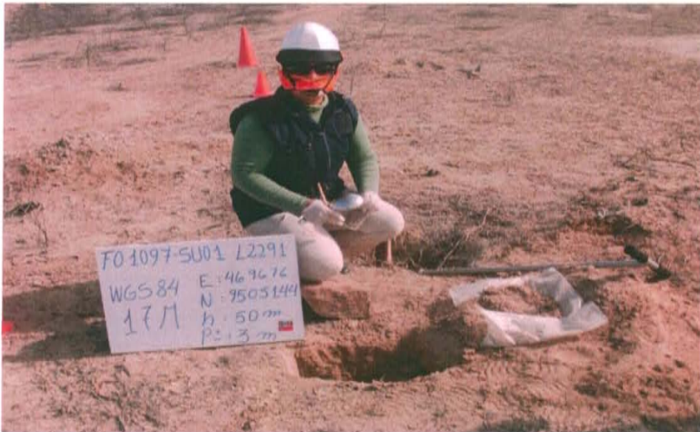
Fotografía N° 4. Toma de muestra de suelo en el punto F01097-SU01 ubicado a 0.8 m del Pozo L2291
