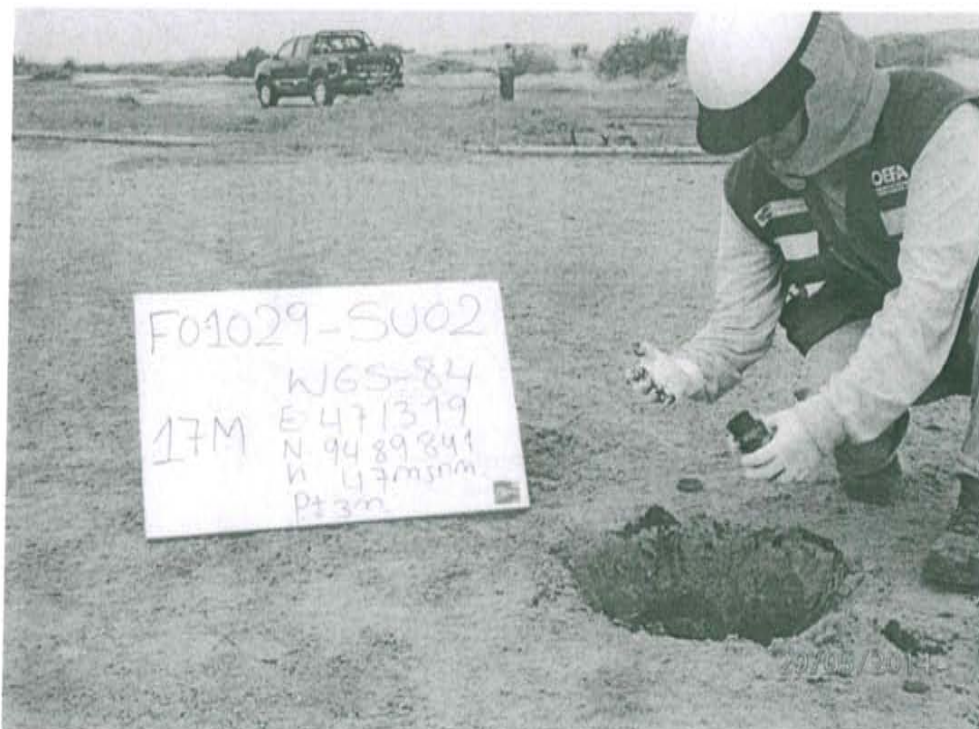
Fotografía 2. Toma de muestra de suelo a 25 m del Pozo T4039 y a una profundidad de 0,25 m de la superficie del suelo.
