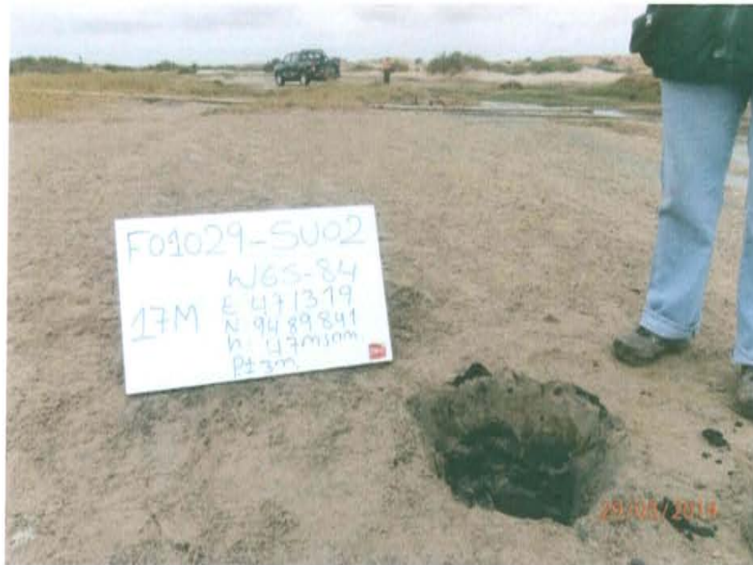
Fotografía N° 4. Toma de muestra de suelo de F01029-SU02 a 25 m del Pozo T4039 y a una profundidad de 0,25 m de la superficie del suelo.
