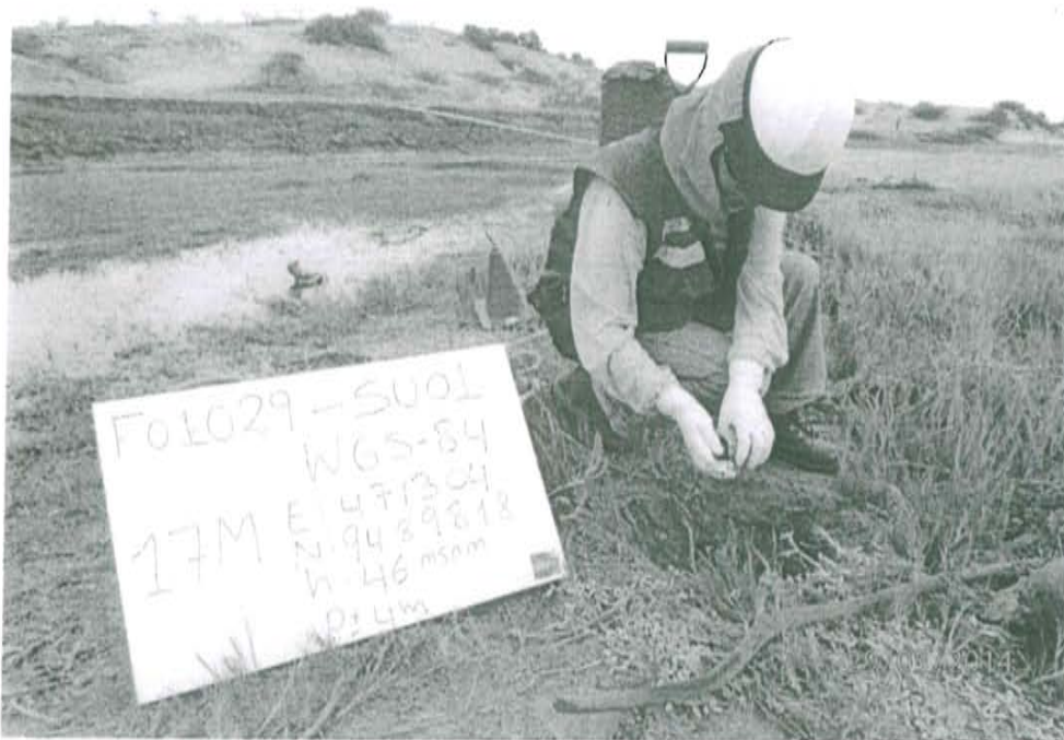
Fotografía 1. Toma de muestra de suelo a 1,50 m del Pozo T4039 y a una profundidad de 0,20 m de la superficie del suelo.
