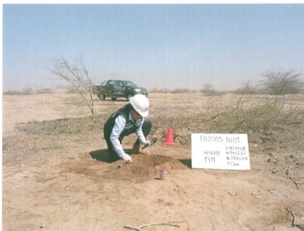
Fotografía N° 3. Toma de muestra en el punto F02085-SU01, ubicado a 2 m aproximadamente del Pozo T2526.
