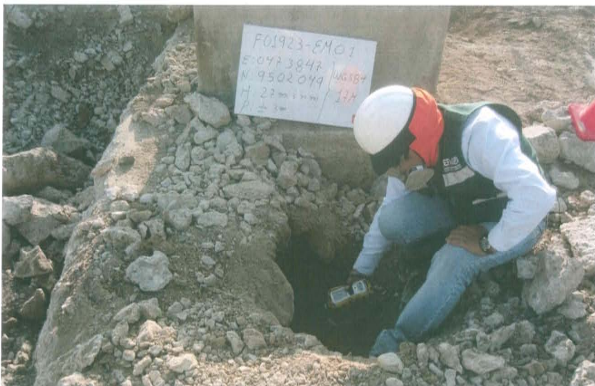
Fotografía N° 5. Medición en el punto F01923-EM01, ubicado en la fuente de emisión en boca del Pozo T3947.
