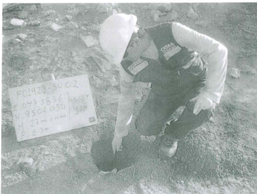
Fotografía N° 2. Toma de muestra de suelo en el punto F01923-SU02, ubicado a 6 m aproximadamente del Pozo T3947.
