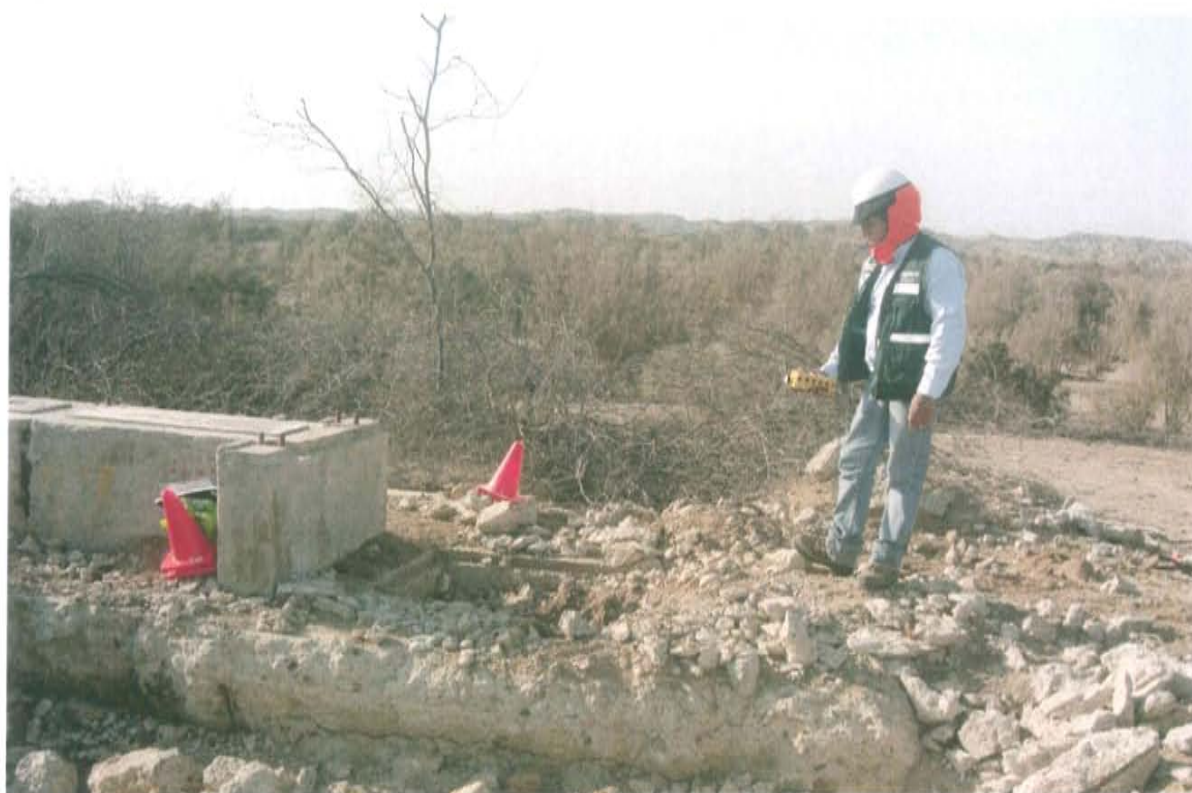
Fotografía N° 6. Mediciones en el punto F01923-VA01, se realizó un recorrido en el área circundante alrededor del Pozo T3947 en un radio de 1 m, con una duración de 10 minutos.
