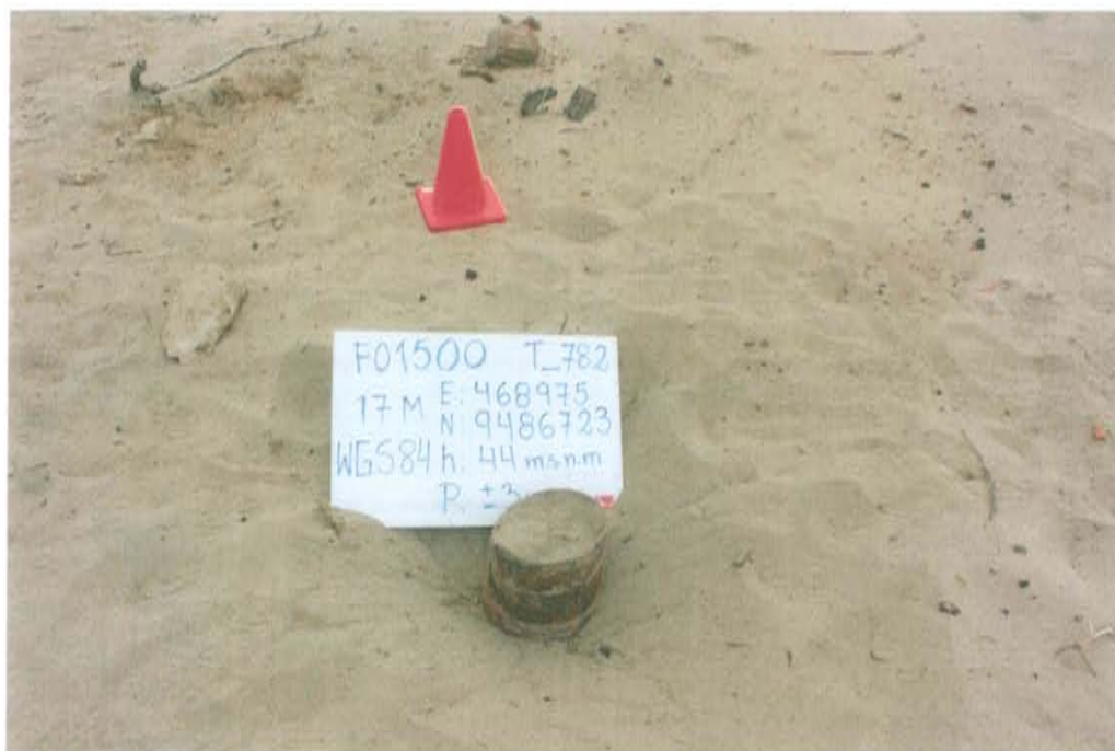
Fotografía N° 1. Vista del Pozo T_782, presenta casing abierto con arena en su interior.
