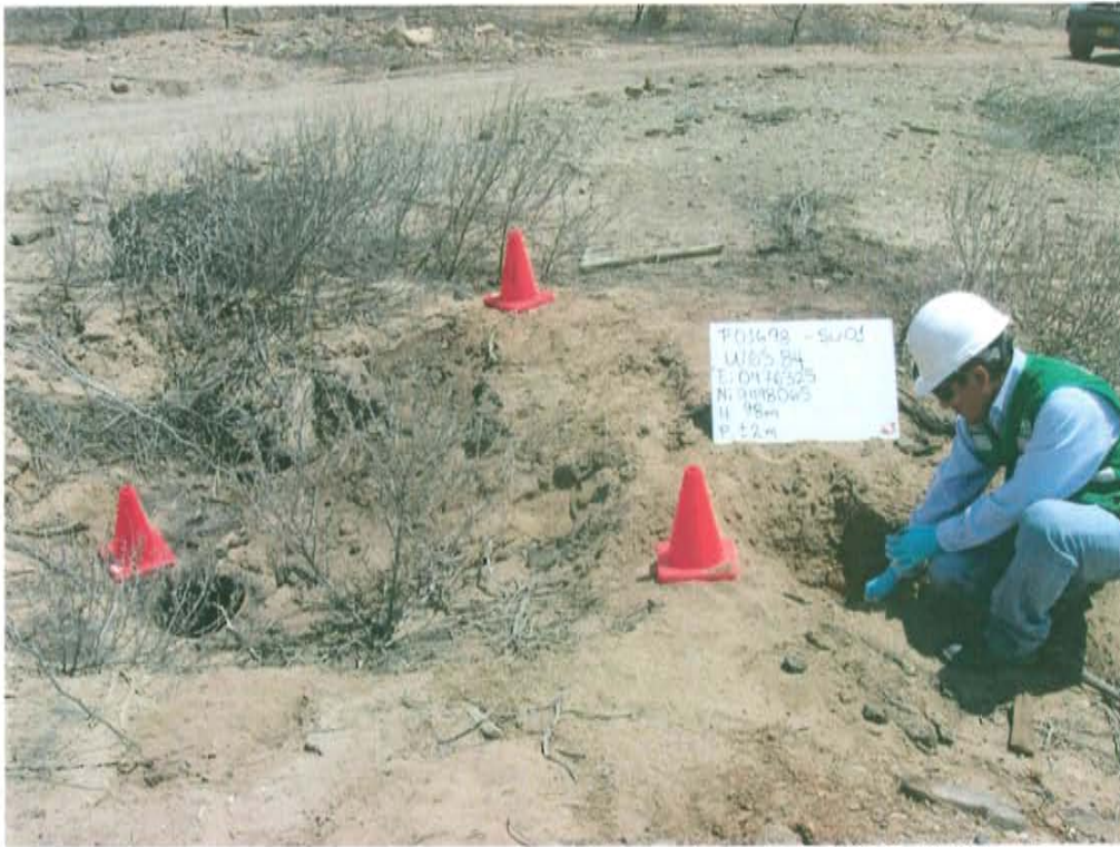
Fotografía N° 3. Toma de muestra de suelo en el punto F01698-SU01 ubicado a 1,5 m al norte del Pozo T3045.
