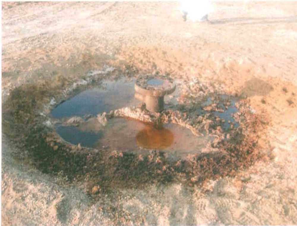
Fotografía N° 1. Pozo con código PERUPETRO LJ_68 inactivo mal abandonado sobresale una altura de 0,35 m sobre el nivel de la superficie.
