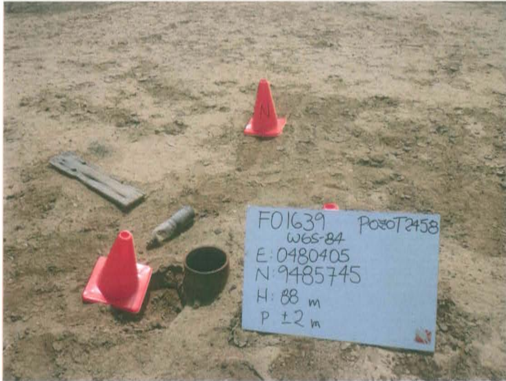
Fotografía N° 1. Pozo inactivo de la ficha F01639 que muestra casing de superficie a 0,31 m sobre el nivel del suelo.
