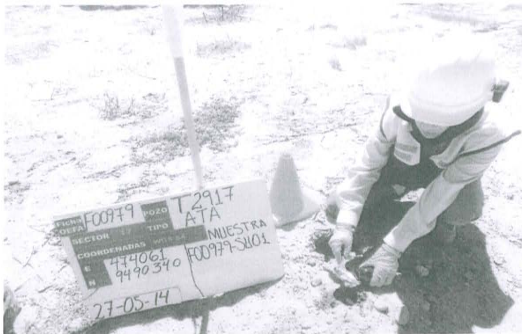
Fotografía N° 1. Toma de muestra de suelo en el punto F00979-SU01, ubicado a 0,30 m de distancia del Casing, Pozo T2917.
