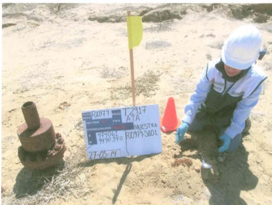
Fotografía N° 4. Muestra de suelo tomada a 1 metro de distancia del pozo T2917.
