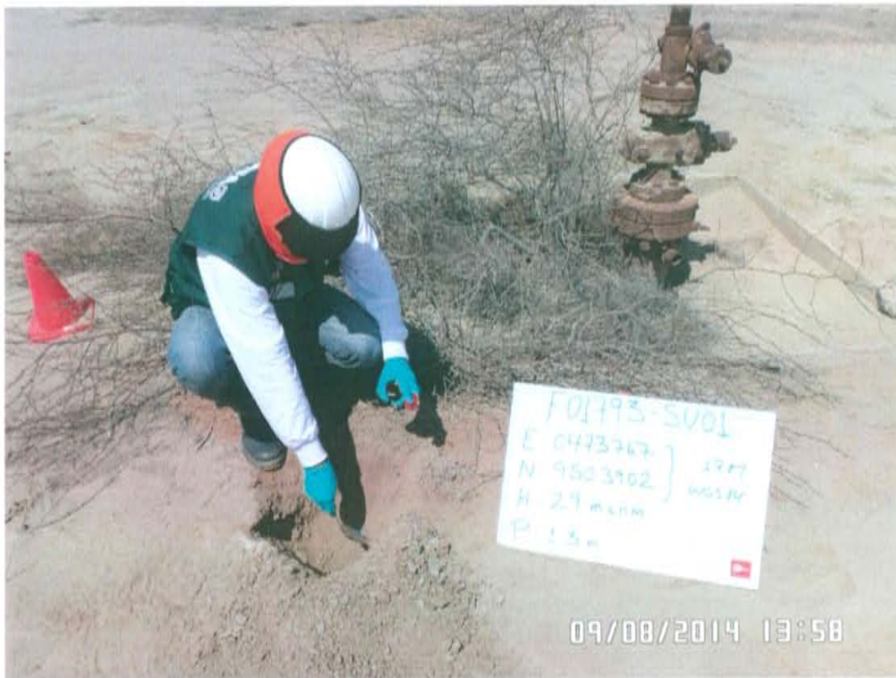
Fotografía N° 3. Toma de muestra de suelo en el punto F01793-SU01 ubicado a 2 m al noroeste del Pozo T6476.
