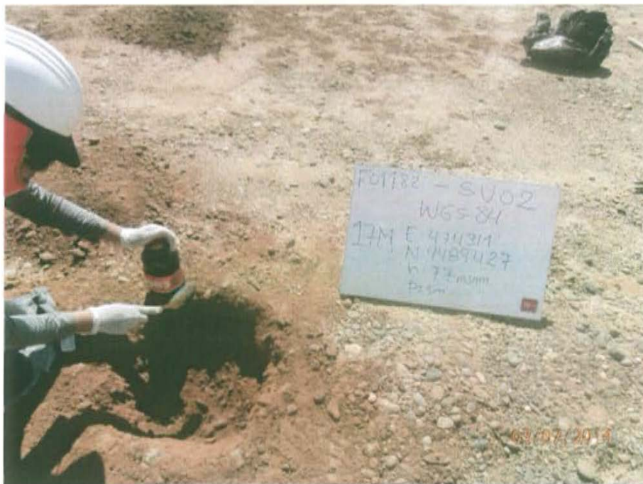
Fotografía N° 4. Toma de muestra de suelo en el punto F01182-SU02, ubicado a 8 m del Pozo T4845.
