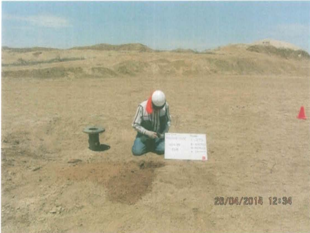
Fotografía N° 3. Toma de muestra de suelo en el punto F00958-SU01, ubicado a 2.4 m de distancia del casing del Pozo L_293.
