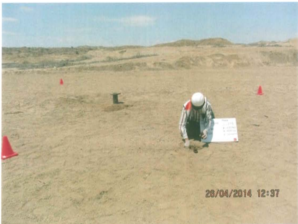
Fotografía N° 4. Toma de muestra de suelo en el punto F00958-SU02, ubicado a 9 m de distancia del casing del Pozo L_293.
