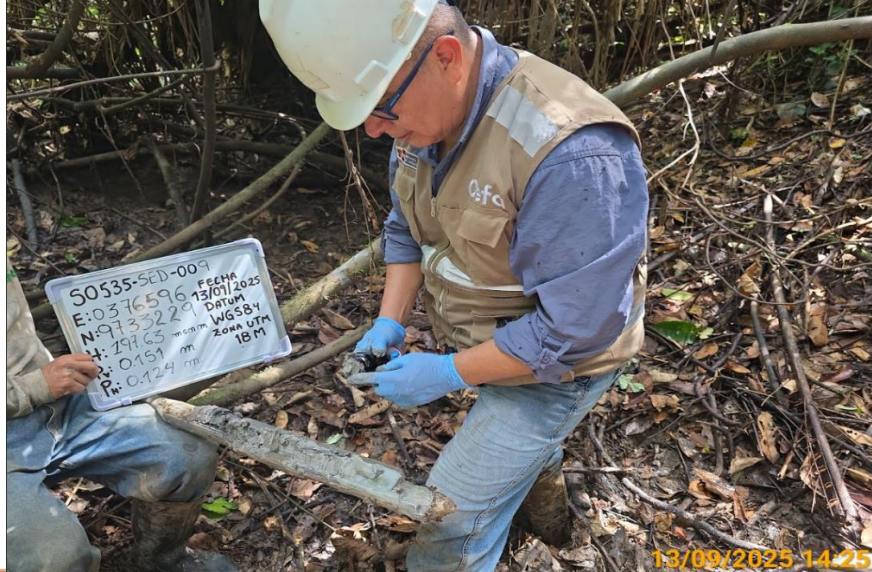
Vista de la toma de muestra de sedimento con código S0535-SED-009 ubicado en el tramo de la quebrada S/N proveniente de la Plataforma 1604, el cual no presentó flujo de agua durante la evaluación. Se observó sedimento con color y olor a hidrocarburos en la muestra
