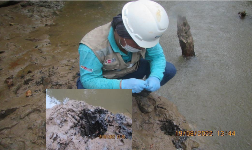
Vista de la toma de muestra de sedimento con código S0535-SED-001 ubicado en el tramo de la quebrada Manchari, tomada durante el reconocimiento del 2022. Se observó sedimento con color y olor a hidrocarburos en la muestra
