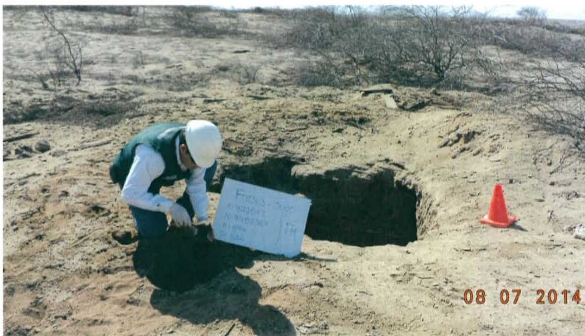
Fotografía N°3. Toma de muestra de suelo en el punto F01363-SU01, ubicado a 1,8 m aproximadamente del Pozo T1765.
