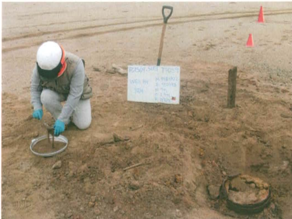
Fotografía N° 4. Muestra de suelo F01569-SU01 se observa ligera impregnación con hidrocarburos.
