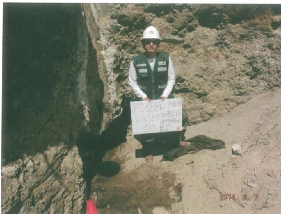
Fotografía N° 1. Pozo inactivo con código PERUPETRO T4215, se observa casing a nivel del suelo con presencia de fluido en su interior además se percibe ligera emisión de gases.
