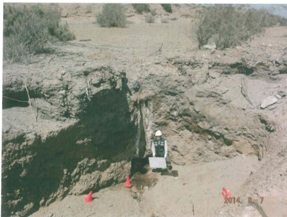
Fotografía N° 2. Pozo inactivo en terreno no habilitado que se encuentra dentro de hoyo de aproximadamente 3,7 m de profundidad.
