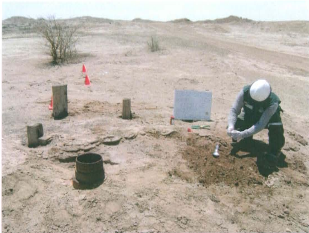
Fotografía N° 3. Toma de muestra de suelo en el punto F00524-SU01, ubicado aproximadamente a 1 m al este del Pozo T2553.
