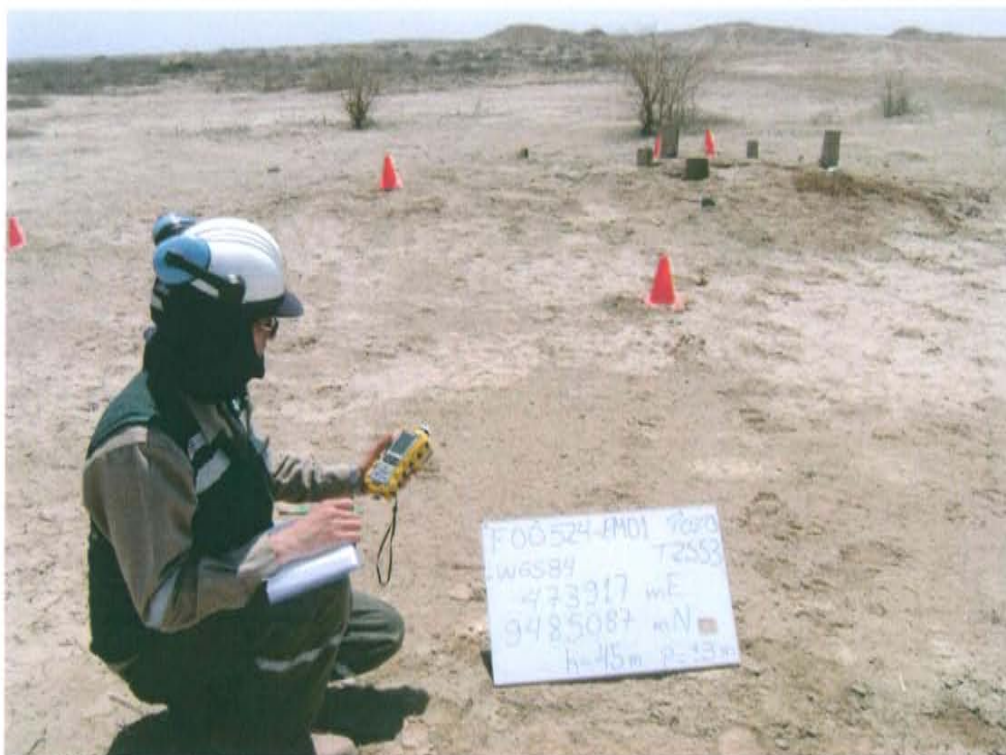
Fotografía N° 4. Medición en el punto F00524-EM01, ubicado a 6 m de distancia de la fuente de emisión a barlovento.
