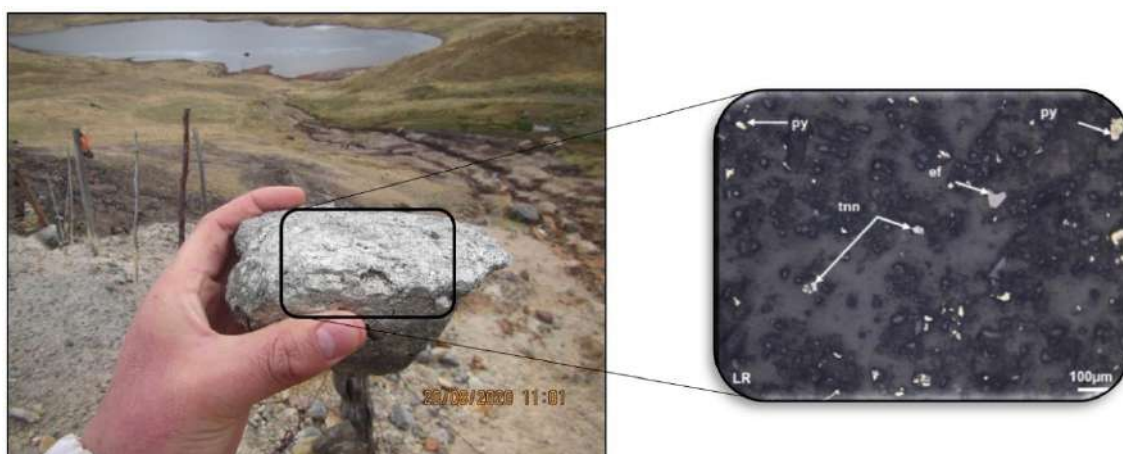
Figura 7.2. Resultado de presencia de minerales en el punto CS-CP6-1, material de relleno del cerco perimetral del polvorín
