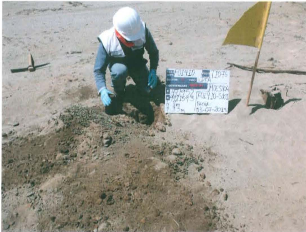
Fotografía N° 3. Toma de muestra de suelo en el punto F01410 -SU01, ubicado a 1,2 m del Pozo T1076.
