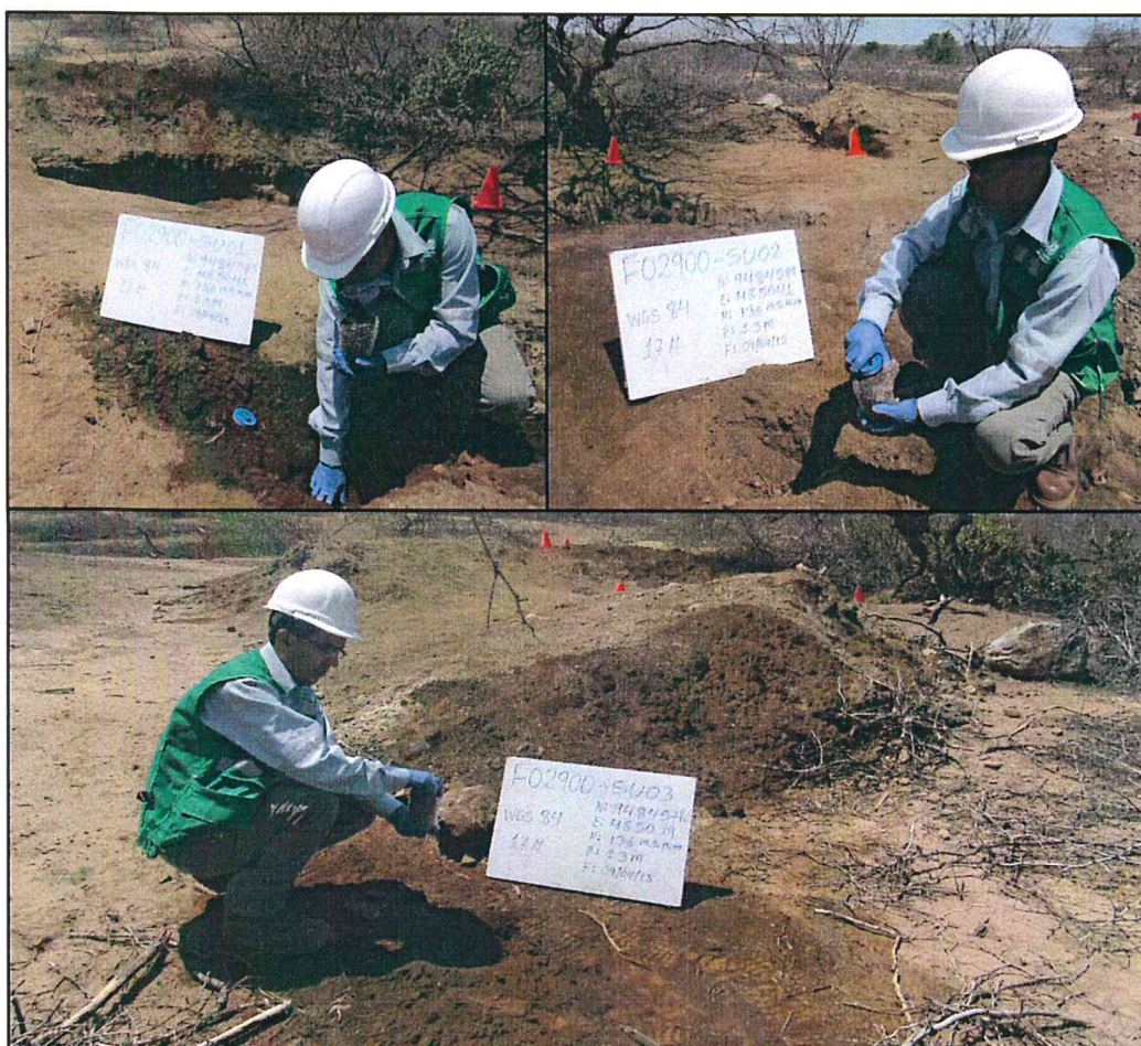
Fotografía N° 3. Toma de muestras de suelo en diversos puntos en el área circundante al hoyo que contiene al pozo con código PERUPETRO T2045.
