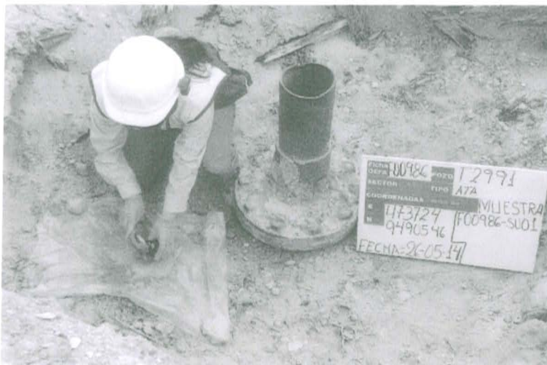
Fotografía N° 1. Toma de muestra de suelo en el punto F00986-SU01, ubicado a 1,10 m de distancia del Casing, Pozo T2991.
