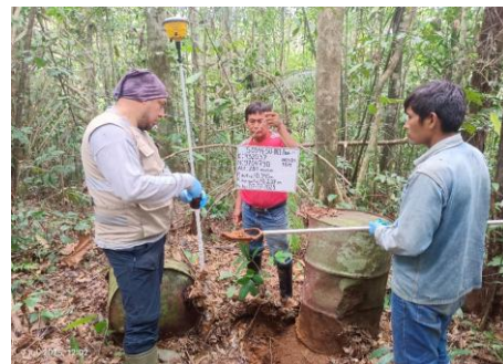
Vista de la toma de muestra de suelo con código S0544-SU-001-PROF. Se observó suelo húmedo de textura arcillosa y sin indicios organolépticos de presencia de hidrocarburos.
